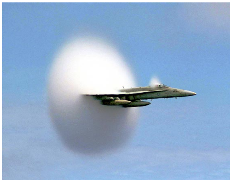
Rysunek 10.7.2: Fala uderzeniowa wytwarzana przez skrzydła odrzutowca Navy FA18. Jest ona widoczna gdyż gwałtowny spadek ciśnienia powietrza w fali uderzeniowej powoduje kondensację cząsteczek wody w powietrzu i powstanie mgły
