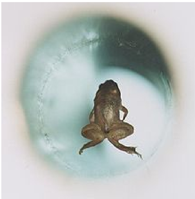
Rysunek 18.4.1: Lewitująca żaba w niejednorodnym polu magnetycznym
